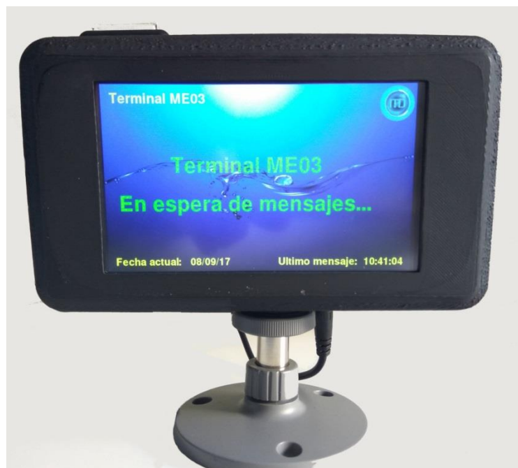
Figura 2. Monitor Embarcado para instalación en salpicadero.
