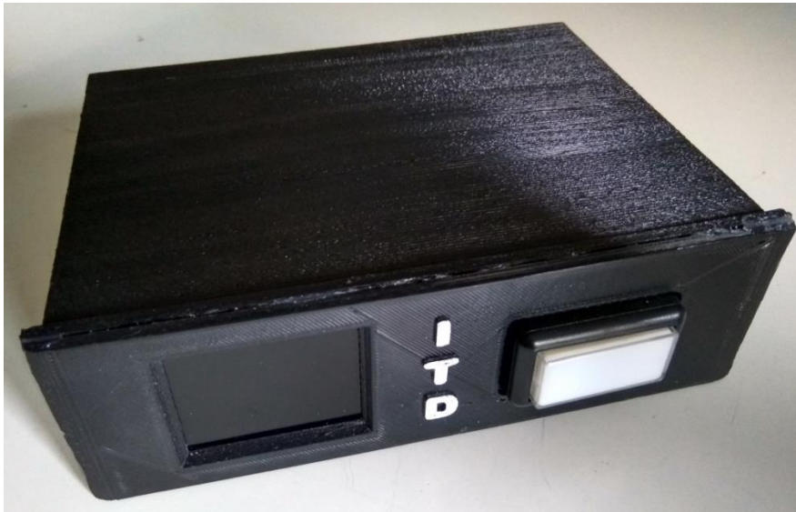
Figura 3. Monitor Embarcado en formato DIN.
